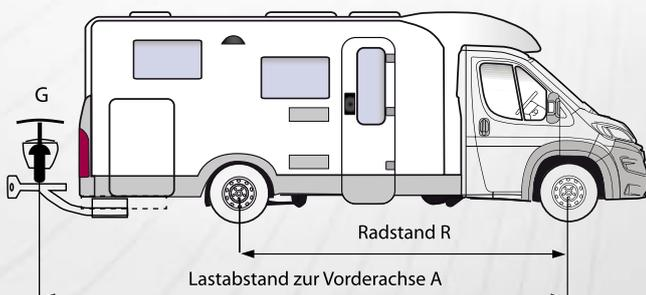
320 cm und der Abstand Träger bis zur Vorderachse beträgt 470 cm, dann ergibt sich eine zusätzliche Hinterachslast von ca. 220 kg.
