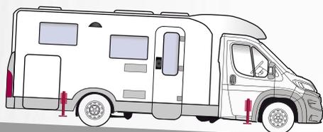
Ausrichten in der Längsachse
